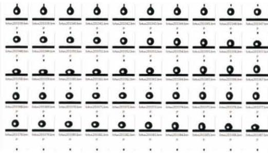
750帧/秒高速摄像机拍摄的超疏水荷叶上水滴弹跳效果序列图
