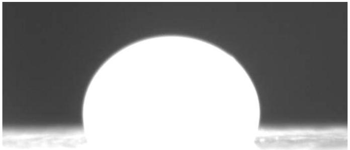
2、超高温条件下的熔液表面张力测试：在超高温熔化的条件下，被测物的熔液外形轮廓可以用以表征其表面化学性质。采用停滴法 (Sessile drop method)，通过分析液滴的轮廓并将使用 Young-Laplace 方程，就可以分析得到熔液的表面张力值及其相应的体积大小。
