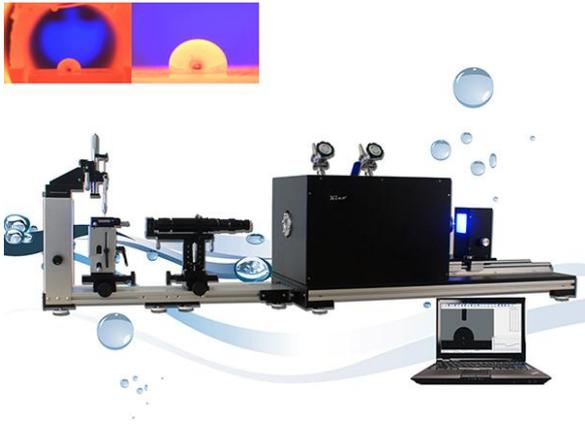
SL200HT 系列超高温表面张力及接触角测试模块，是专门针对温度条件要求非常特殊的行业如矿物、冶金、制陶、瓷釉、焊接、半导体、玻璃、合金材料研制和煤炭等行业的影像分析法界面化学分析系统。整机包括了特殊设计的超高温炉膛以及专业的光学成像系统、精密机械调整结构等，可用于分析高温熔液与其他固体材料之间的接触角值以及高温熔液与空气或其他惰性气体的表面张力或界面张力值。
