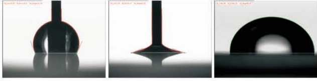
图1 分析方法：曲线尺拟合法（圆拟合、spline拟合、广义二次曲线拟合等）。
